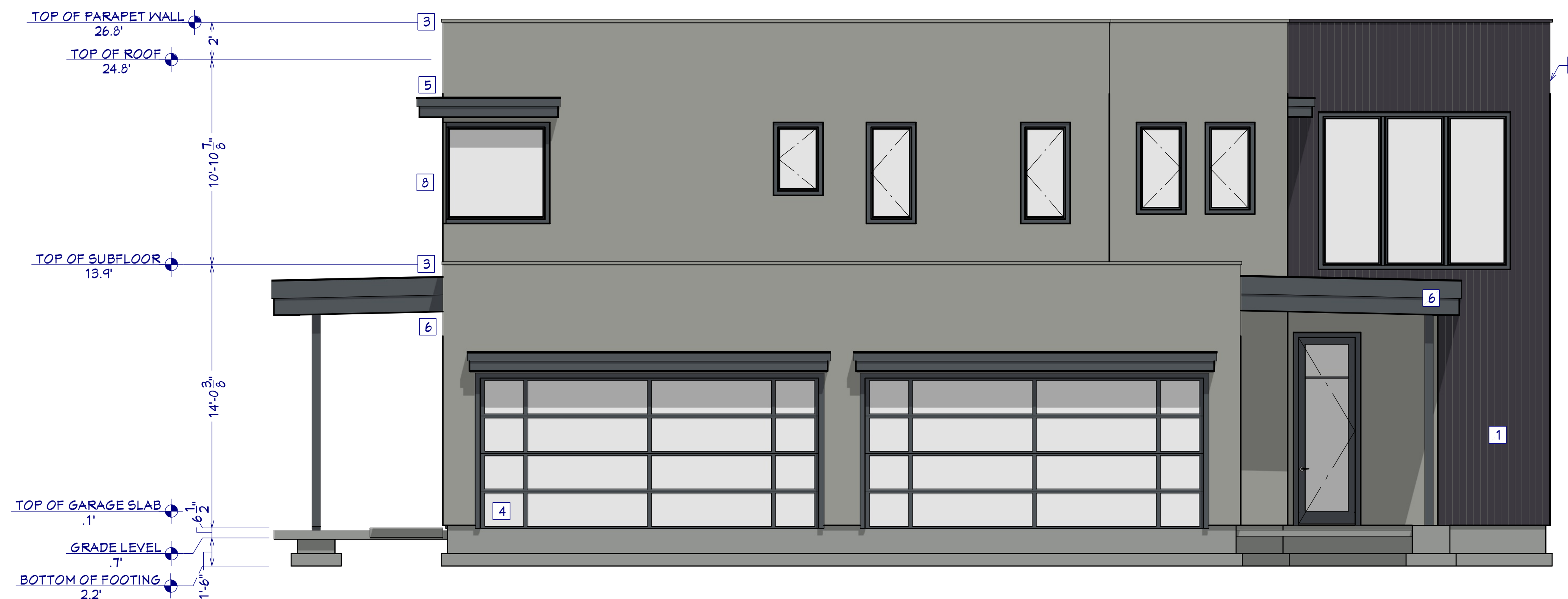
S. SIDE ELEVATION 1/4"=1'
